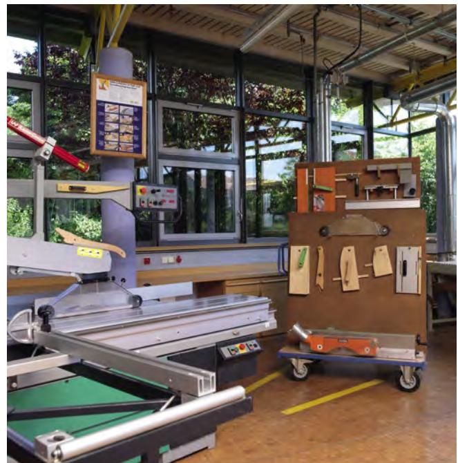
Abb. 2.2.2-04 Formatkreissäge mit zugehörigen Schutzvorrichtungen
