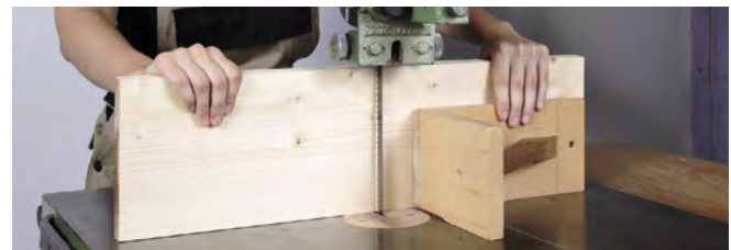
Abb. 3.1.6-08 Quersägen hochkant stehender Werkstücke
