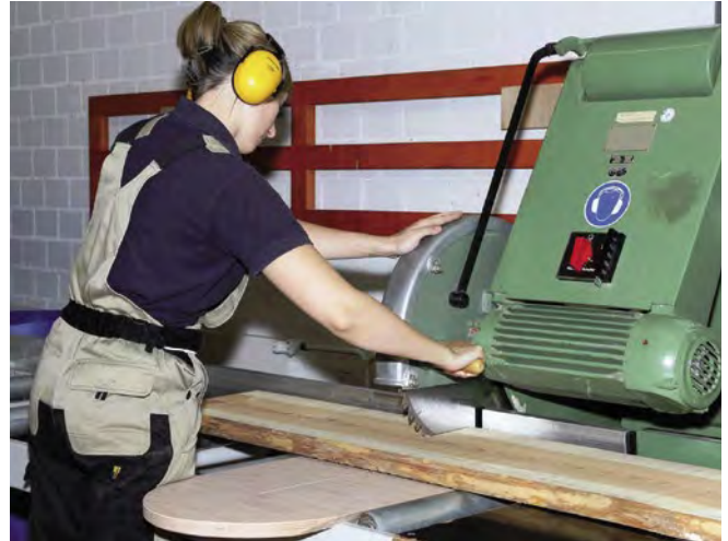
Abb. 3.1.5.06 Handhaltung beim Sägevorgang an einer Pendelkreissägemaschine
