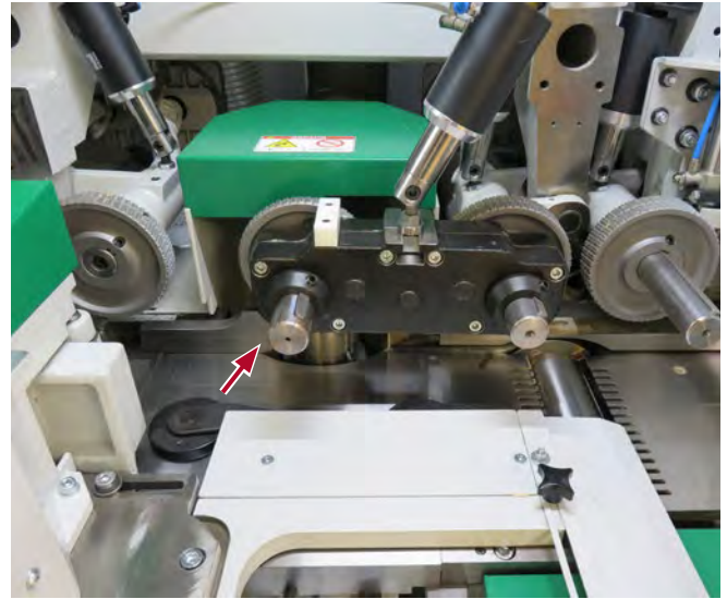
Abb. 3.1.13-05 Verdeckung einer hinteren Vertikalspindel mit Aufsteckspindel
