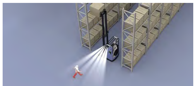
Abb. 3.4.4-04 Personenerkennung in einem Schmalganglager
