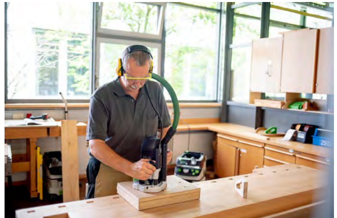
Abb. 3.3.2-02 Maschine an Absaugeinrichtung anschließen
