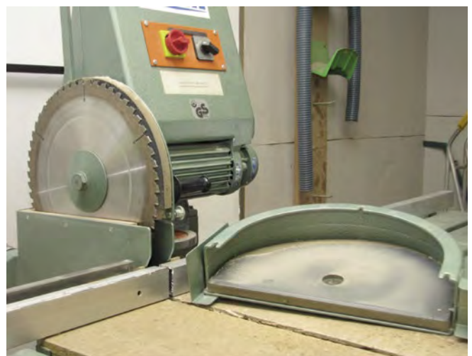
Abb. 3.1.5-07 Auskleidung an Schutzhaube zur Lärmreduzierung
