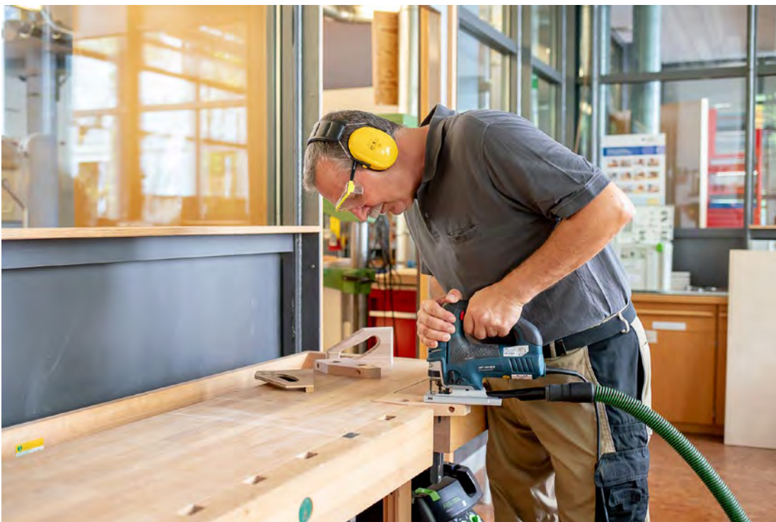
Abb. 3.3.4-02 Werkstücke sicher aufliegen und fixieren
