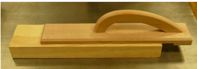
Abb. 3.1.9-05 Zuführlade und Schiebeholz für kurze Werkstücke
