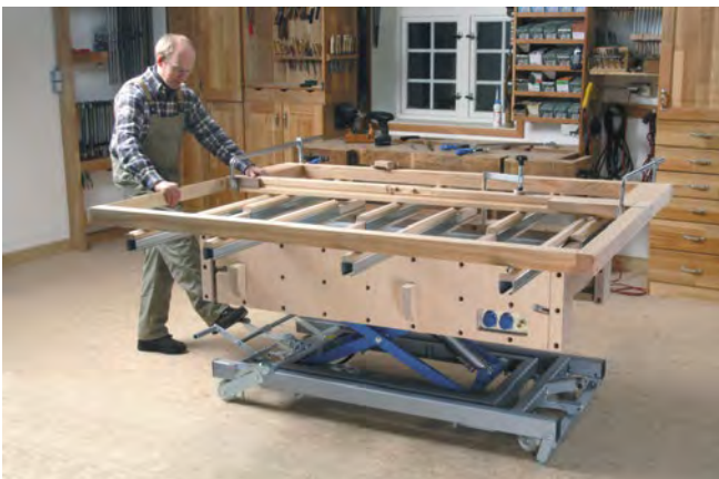
Abb. 3.4.5-03 Scherenschubtisch zur Montage
