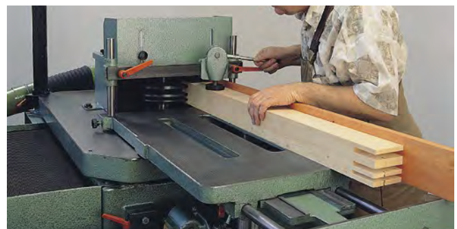
Abb. 3.1.8-05 Handvorschub = Arbeiten mit dem Schiebeschlitten
