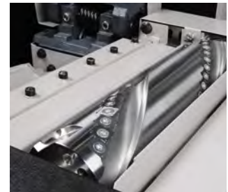
Abb. 3.1.9-08 Spiralhobelmesserwelle mit Einwegwendemessern
