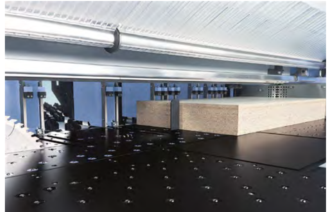
Abb. 3.1.3-02 Hohes Plattenpaket mit Winkelandrückvorrichtung
