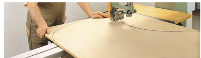
Abb. 3.1.6-09 Sägen sperriger Werkstücke mit zusätzlicher Tischverbreiterung
