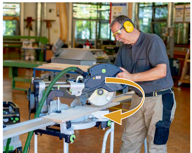
Abb. 3.1.4-05 Sägevorgang beim Einsatz der Zugfunktion
