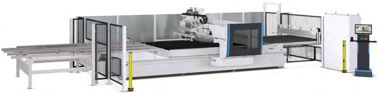
Abb. 3.1.11-01 CNC-Bearbeitungszentrum mit Schutzzaun und Kontakttrittmatte
