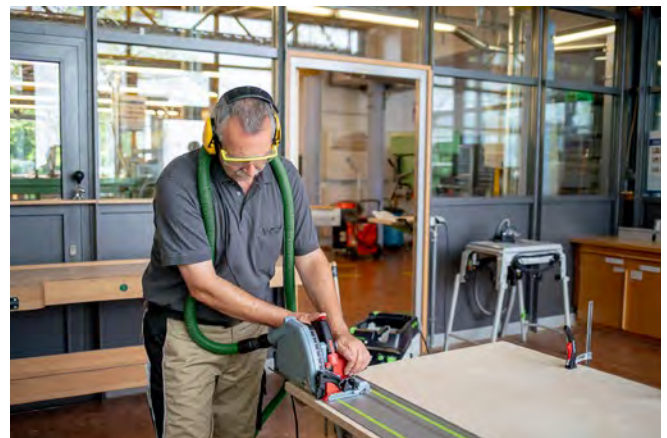
Abb. 3.3.1-11 Sägen mit Führungsschiene
