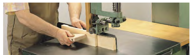
Abb. 3.1.6-10 Sägen kurzer Werkstücke mit Zuführhilfe
