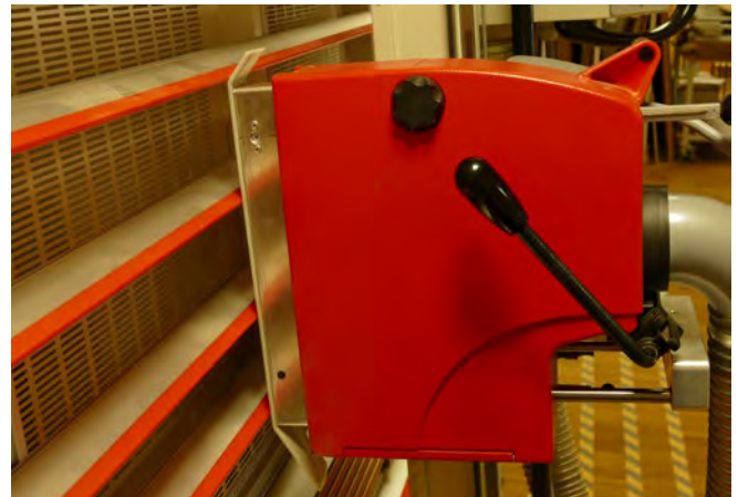
Abb. 3.1.2-05 Druckschuh und Bedienhebel
