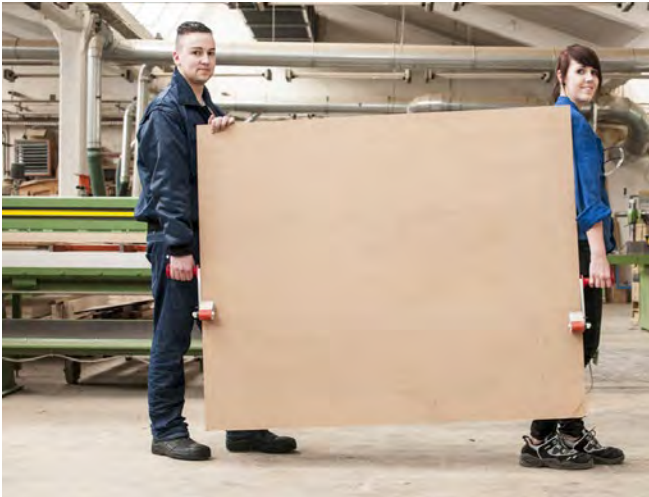
Abb. 3.4.5-01 Tragezangen für Plattenmaterial
