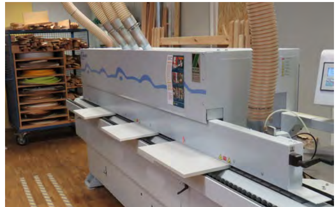
Abb. 3.1.12-04 Kantenanleimmaschine mit Absauganschlüssen
