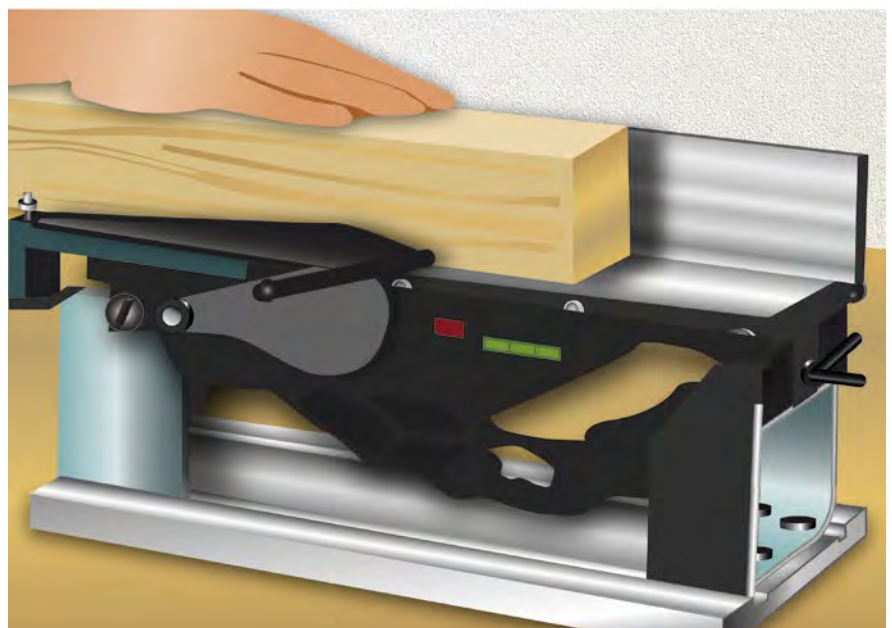
Abb. 3.3.3-02 Elektrohandhobel in stationärer Aufnahme
