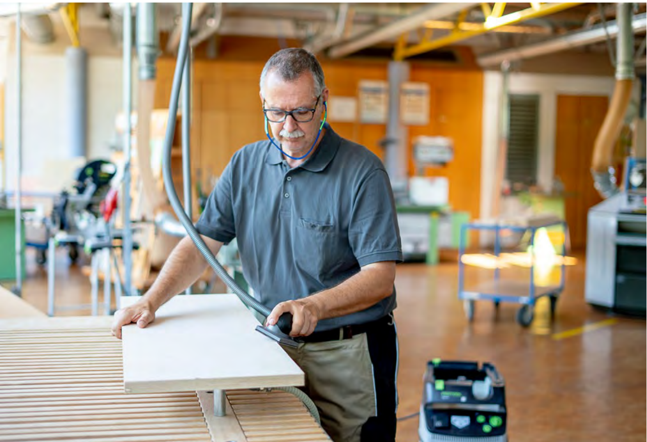
Abb. 3.3.6-01 Handschleifarbeiten mit abgesaugtem Handschleifklotz
