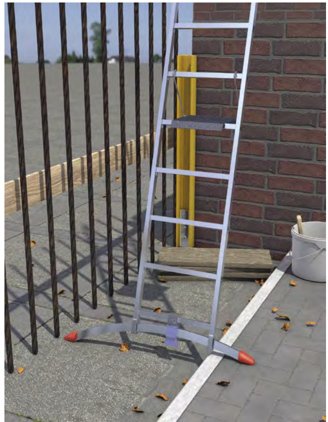
Abb. 3.5.5-02 Leiterfuß zum Ausgleich von Niveauunterschied
