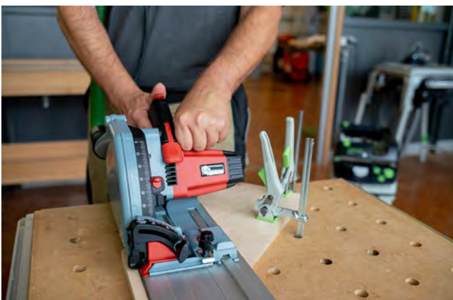
Abb. 3.3.1-10 Sägevorgang mit sicher fixiertem Werkstück
