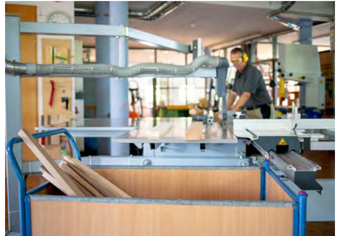
Abb. 3.1.1-05 Sammelbehälter für Materialstücke bereitstellen
