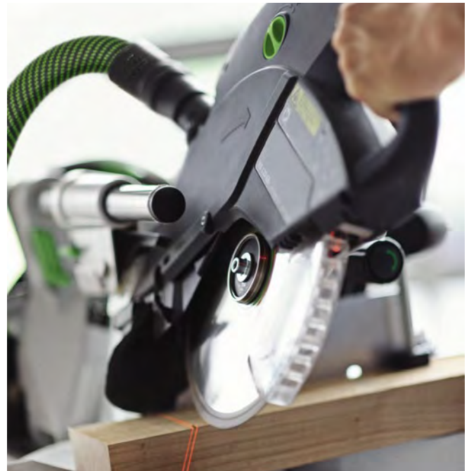
Abb. 3.1.4-04 Laser zur Anzeige der Schnittlinie
